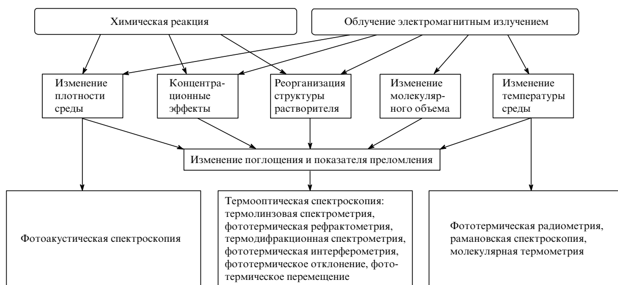
Рис. 2. Основные фототермические эффекты, которые возникают в конденсированных средах, облучаемых лазером, и методы их детектирования.
