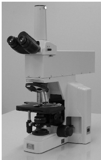
Рис. 10. Фотография серийно выпускаемого термолинзового микроскопа для измерений в микрофлюидных чипах. 314 Опубликовано с разрешения профессора Т.Китамори и доктора М.Токеши (Токийский университет, Институт микрохимической технологии, Япония).
